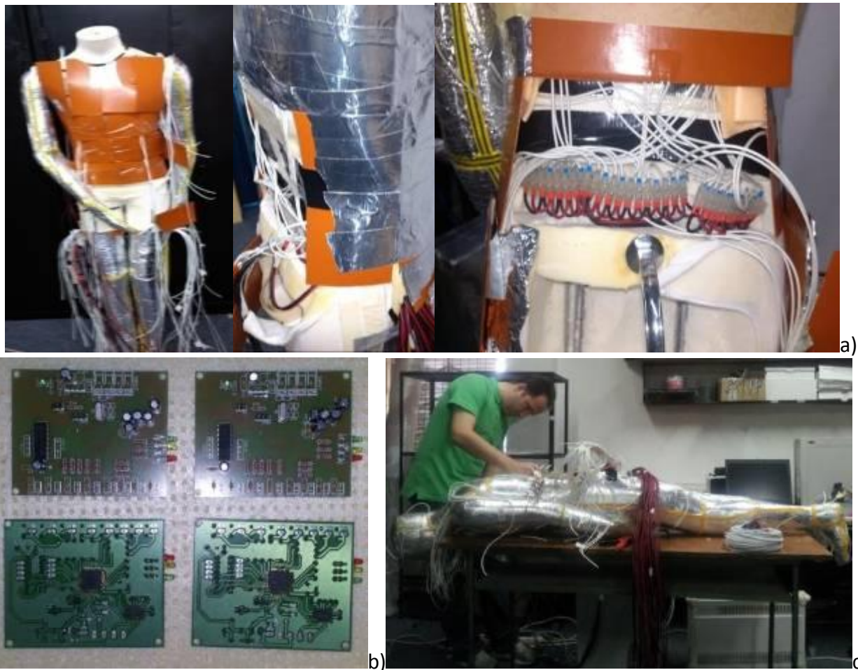
Figura 18: a) Diferite etape de realizare ale noului prototip de manechin termic, b) plăcuțe de control ale zonelor, c) testarea fiecărei zone în parte
